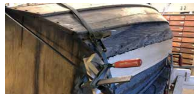
Nytt bord i slaget spänns fast.
