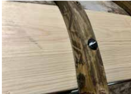
Efter pålimning och hyvling, passning okej!
