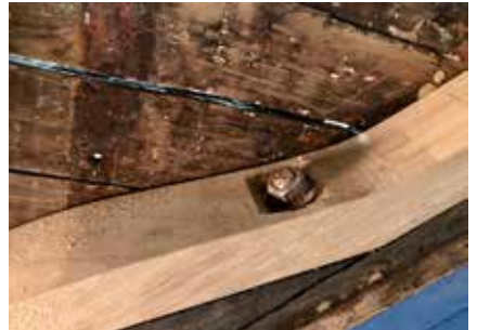
Stävk nät skarvat och löst och temporärt monterat.
