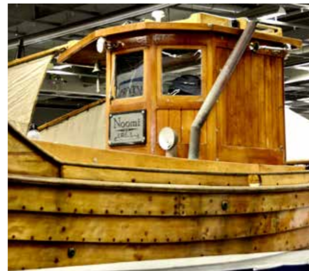
Jullen Noomi med sitt enepinnade skrov och med namnskytten gjord i sten.
